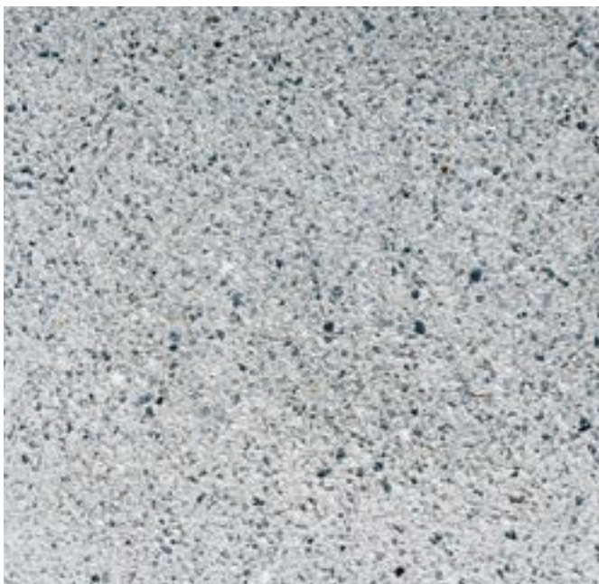
Bild 7: Waschbeton, feingewaschene Oberfläche
