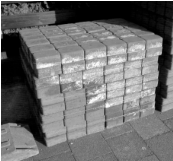
Bild 1: Ausblühungen an paketierten Pflastersteinen in einem Werk für Betonwaren
