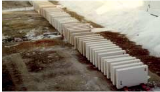
3 Auslagerung der Probekörper an ungeschützter Atmosphäre auf dem Dach des Otto-Graf-Instituts, Universität Stuttgart, 3 Exposure of specimens in an unprotected atmosphere on the roof of the Otto-Graf-Institut, University of Stuttgart
