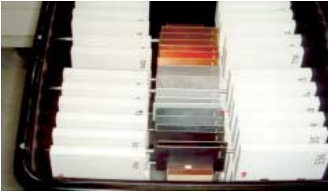
2 Auslagerung der Probekörper in Klimakisten über gesättigter NaCl-Lösung (konst. 75 % rel. Feuchte) bzw. über gesättigter KCl-Lösung (konst. 95 % rel. Feuchte) bei 20 °C 2 Exposure of specimens in climatic cabinets over saturated NaCl solution (const. 75 % rel. humidity) and over saturated KCl solution (const. 95 % rel. humidity) at 20 °C
